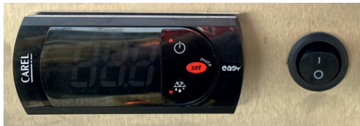
Panel til termostat
